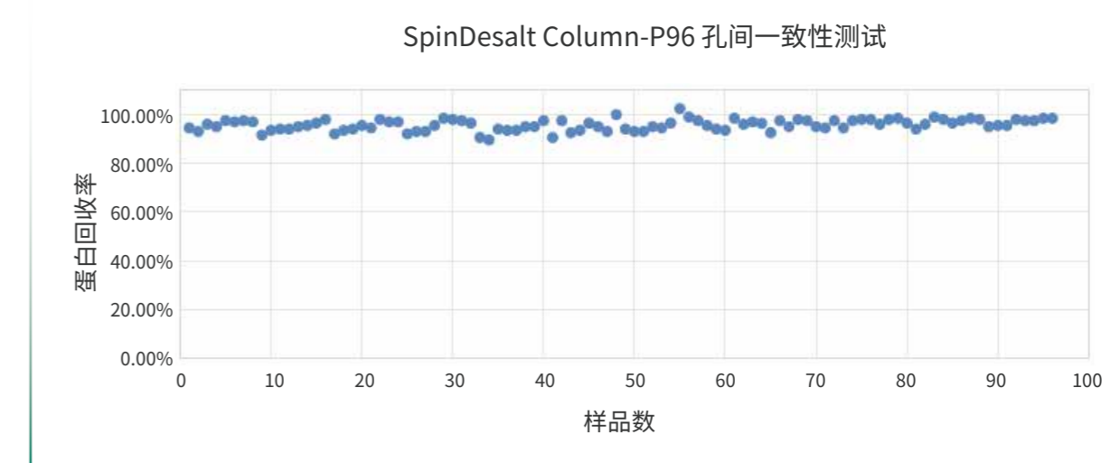
图 5 SpinDesalt Column-P96 一致性效果
